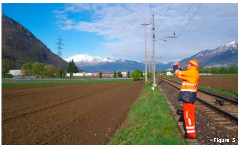
Saisie de la répartition du courant de fuite sur le réseau CFF au Tessin
